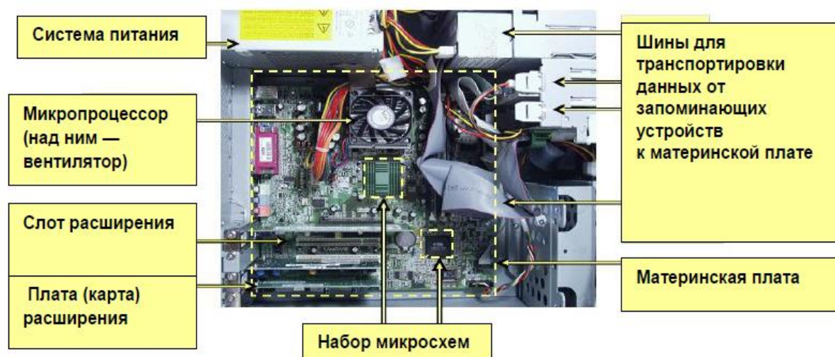
2.4 – Сурет. Жүйелік блоктың ішіндегі компоненттер
