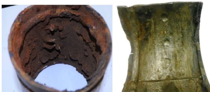
Сурет 1- Құбырдың ішкі коррозиясы - коррозия өнімдерінен тазартуға дейін және кейін
