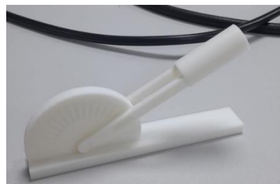
Сурет 42 - Autodesk Inventor бағдарламасында әзірленген гониометр моделі және 3D принтерден шығарылған өнімі
