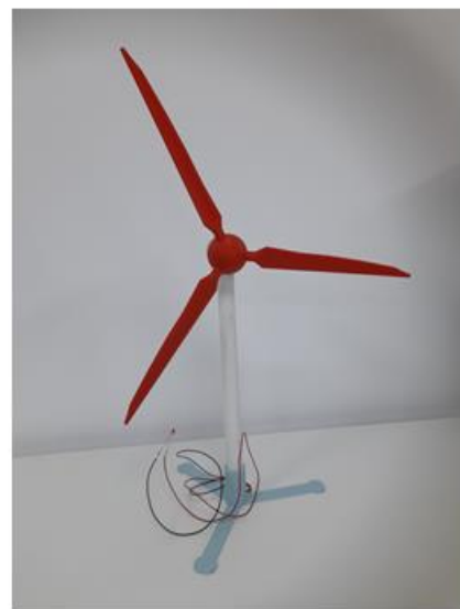
Сурет 23 - 3D принтерлерден шығарылып жиналған жел турбинасының моделі
