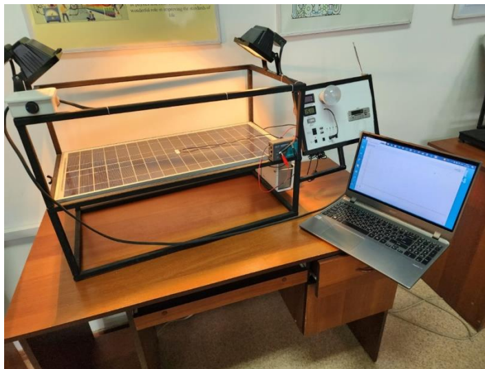
Сурет 16 - Күн энергиясын электр энергиясына түрлендіргіштердің физикалық сипаттамаларын зерттеуге арналған оқу-ғылыми стенді
