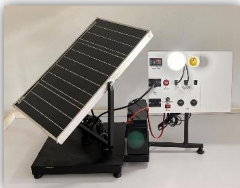
Сурет 32 – Күн панелінің физикалық сипаттамаларын оқу-зерттеу стендтері
