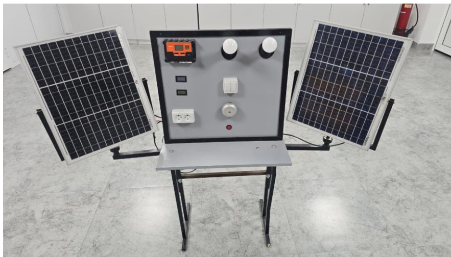
Сурет 11 – «Баламалы энергия көздері» курсына күн панелдерімен байланысты мазмұнда оқытуға арналған қондырғы
