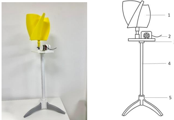
Сурет 34 - STEM білімге негізделген оқу-жаттығу жел генераторы: ротор (1), генератор (2), платформа (3), тік тіреуіш бағана (4) және ұштаған тұғыр (5)
